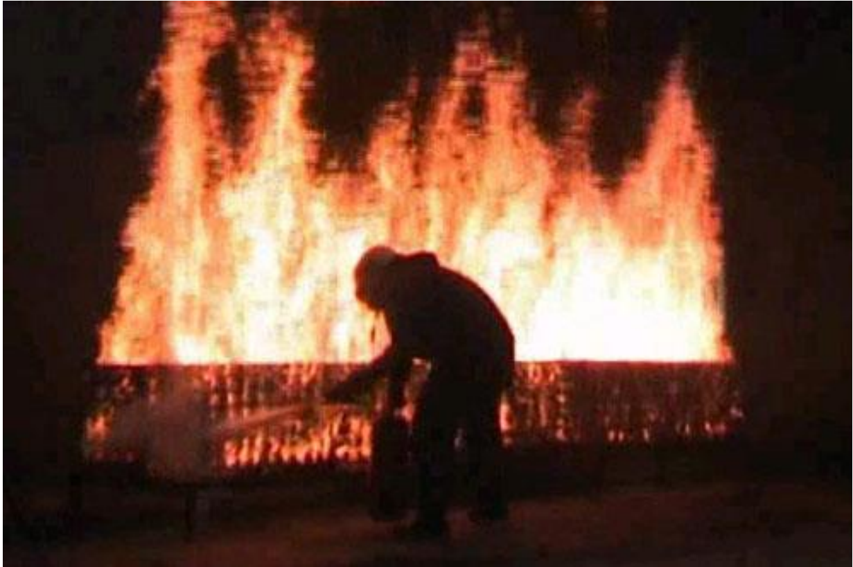
14. ábra Oltási képesség vizsgálat „A” vizsgálati tűz esetén
