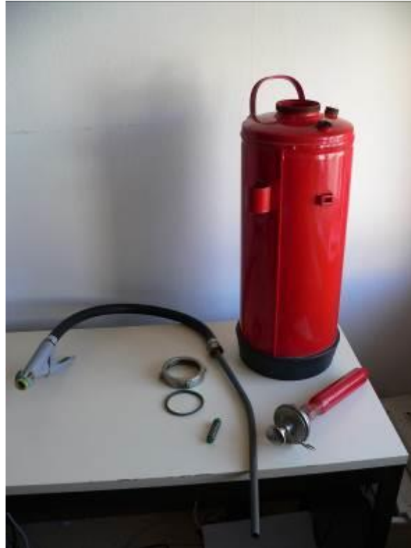
8. ábra Tartály és a készülék tartozékai
