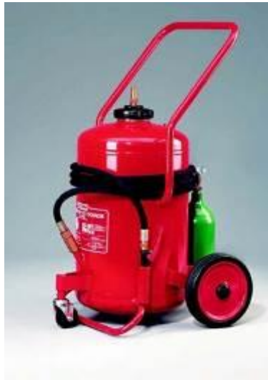
6. ábra Szállítható tűzoltó készülék külső hajtóanyagpalackkal
